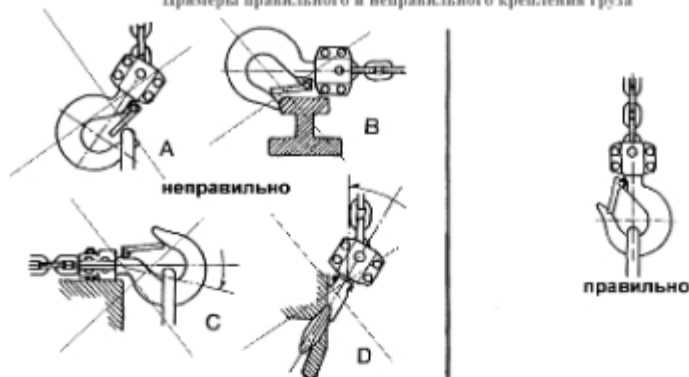
Примеры правильного и неправильного крепления груза
